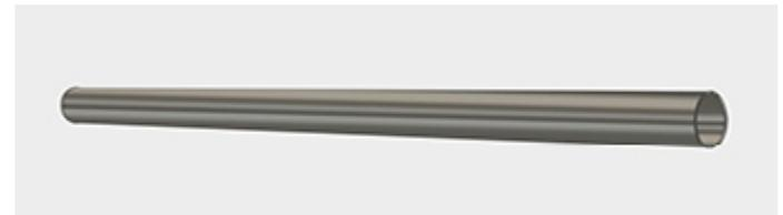
Figura 1. Tubo circular con una longitud de 500mm y diámetro de 25mm.
